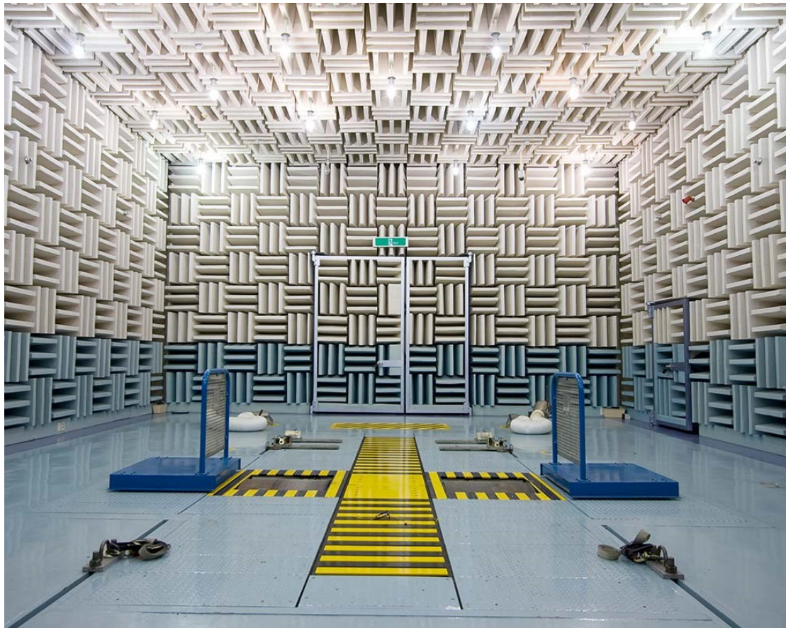
Rys. 2. Komora semibezechowa na uniwersytecie w Seulu [3]
