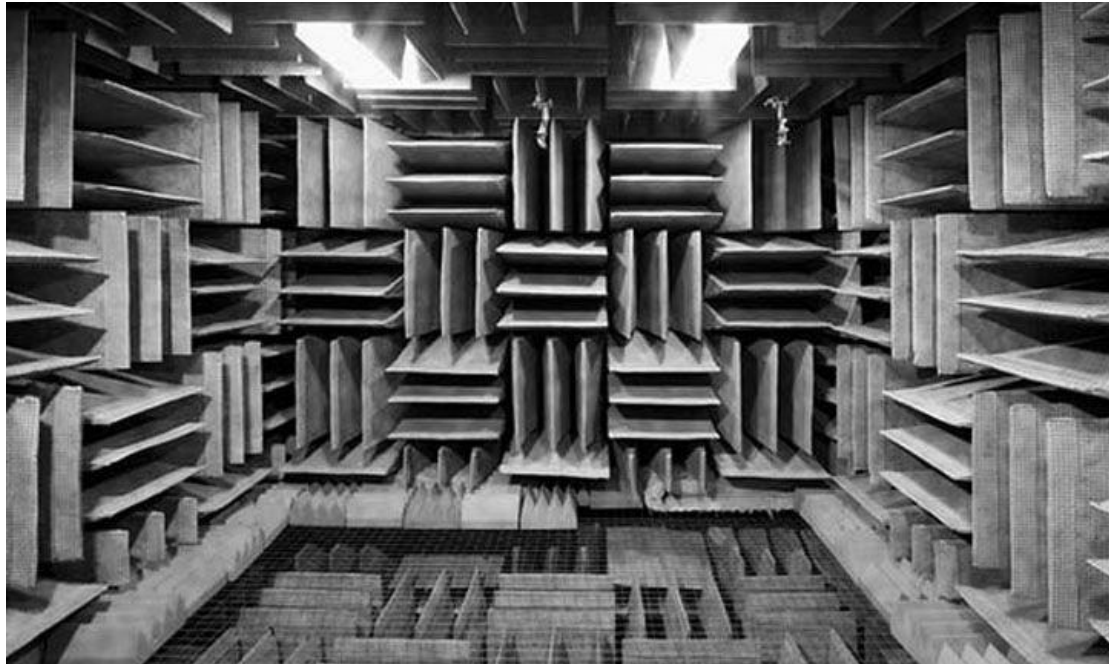
Rys. 1. Komora bezechowa Microsoftu – najcichsze miejsce na Ziemi [2]
