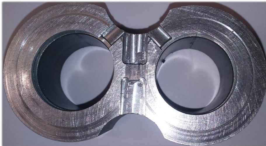
Rys. 7. Rowki odciążające w korpusie łożysk ślizgowych
