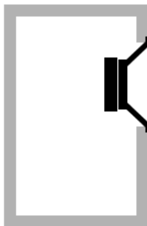
Rys. 12. Schemat budowy obudowy zamkniętej [14]
