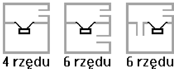
Rys. 16. Schemat budowy obudowy pasmowoprzepustowej [14]
