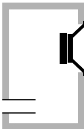
Rys. 13. Schemat budowy obudowy typu Bassreflex [14]
