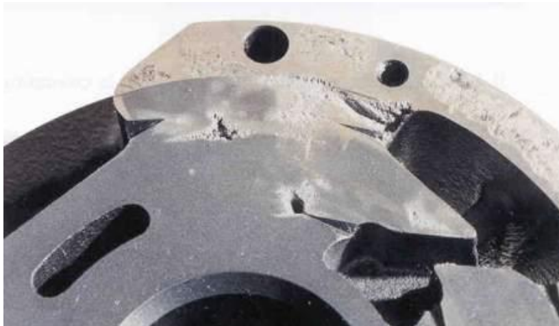
Rys 7. Przykład zużycia ( erozji kawitacyjnej ) płyty bocznej pompy łopatkowej
